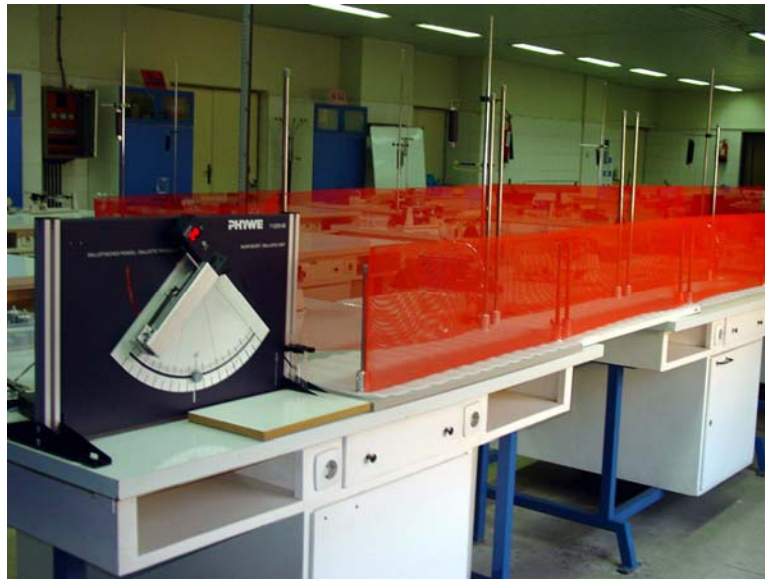
شکل ۵- دستگاه پرتاب به همراه میز فرود
