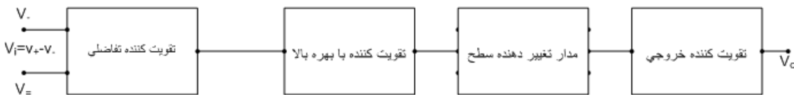
شکل (۲) طبقات به کار رفته شده در op-amp
