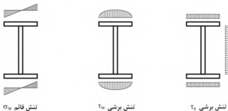
شکل ۱۰-۲-۸-۲ توزیع تنش در مقاطع I شکل تحت اثر لنگر پیچشی.
