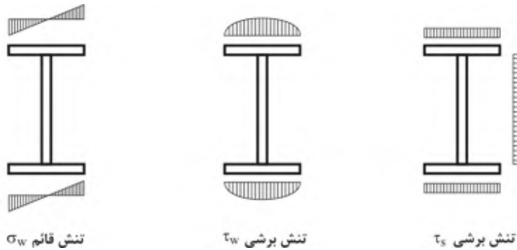
شکل ۱۰-۸-۱ توزیع تنش در مقاطع I شکل تحت اثر لنگر پیچشی.
