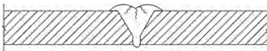
شکل ۱۷-۵-۶-۳-ب ترک‌های ستاره‌ای در سطح جوش.
