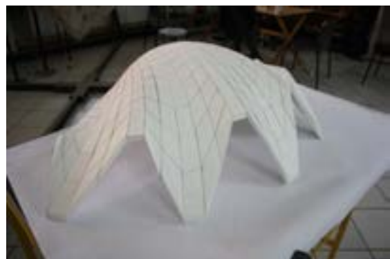
ت ۲۰. مدل مقوایی یک کفه از صدف دو کفه‌ای (مقیاس 1/1 )، در ساخت و برپایی صدف از هزار متر پلات و هزار گیره کاغذ استفاده شد.
