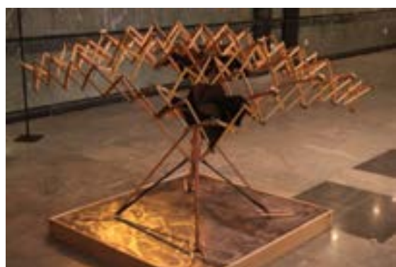
ت ۶. مدل باز و بسته شونده چوبی - چتر (یک تیپ قطعه و اتصال).
