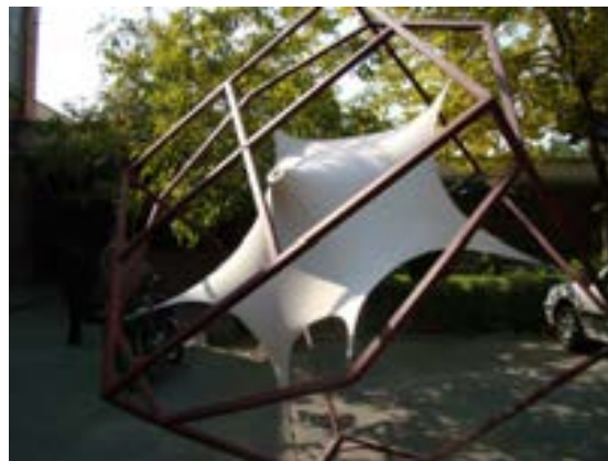
ت ۱۲. مدل غشای نازک (۱/۲ مقیاس از متقال).
