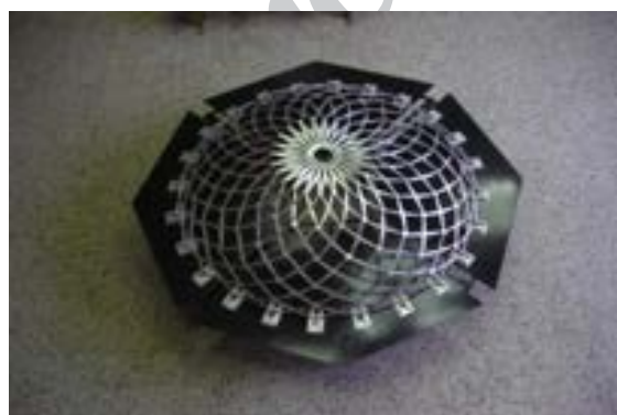
ت ۷. گنبد آلومینیومی ایریس (گنبد لاملا متشکل از شش تیپ قطعه و اتصال).
