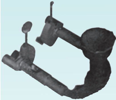
ب- جوشیدن حاصل از سیستم راهگامی ناصحیح، رطوبت زیاد و هواکش ناکافی
