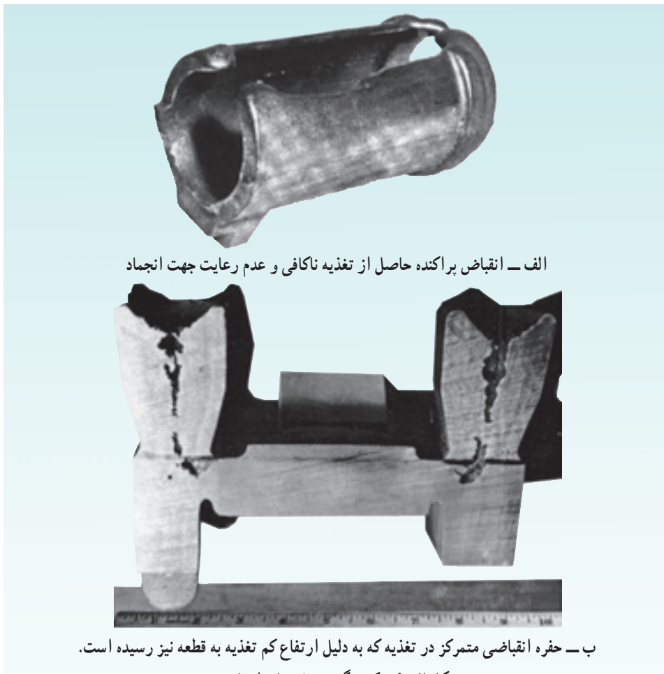
شکل ۲-۹— کشیدگی و حفره‌های انقباضی
