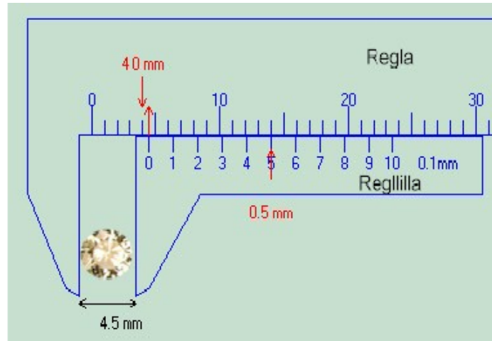
شکل ۲- اساس کار کولیس
