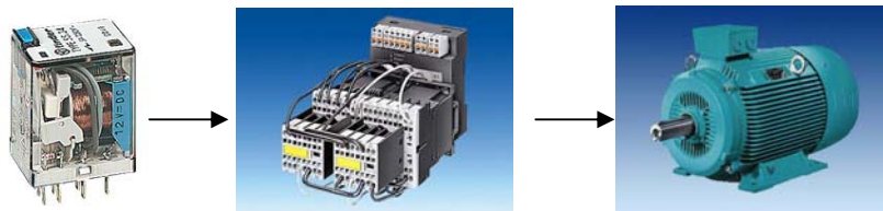
شکل ۱۰-۳ : نمونه ای از تحریک کردن بوبین یک رله
