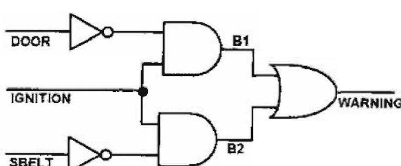
شماتیک مدار هشدار دهنده
