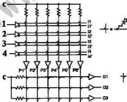
۱. مدار داخلی GAL20V8
