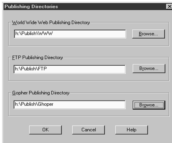
شکل ۱۸-۱ نصب IIS و مشخص کردن فهرست‌های ریشه
