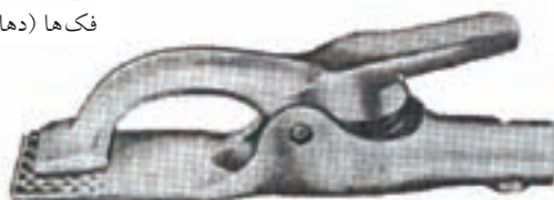
شکل ۷-۳۲- گیره اتصال به قطعه کار
