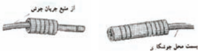
شکل ۲۹-۷- نمونه اتصال کابل‌ها به یکدیگر
