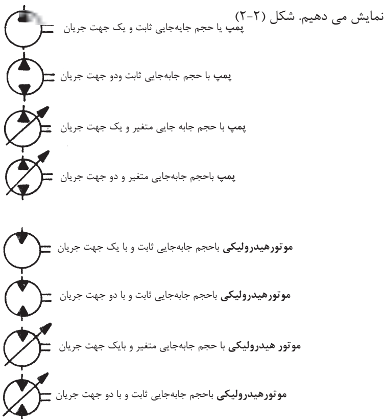
شکل ۲-۲- نمادگرافیکی هیدروپمپ‌ها و هیدروموتورها
