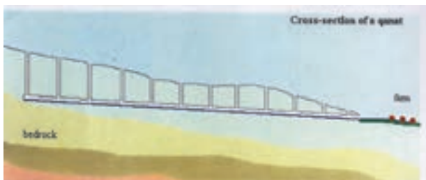
شکل (۱-۱) - سطح مقطع قنات و کانال آن
