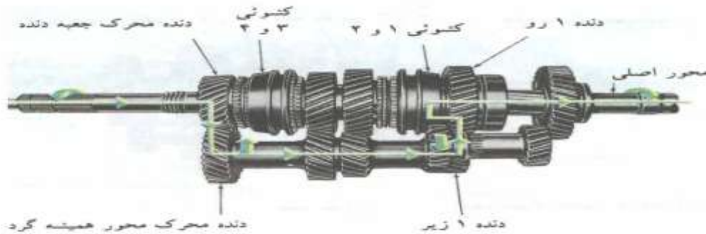
شکل ۳۸ - حالت دنده ۱ با حرکت کشتونی بطرف دنده ۲
