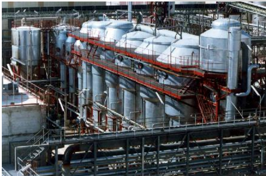
شکل 10-9- تصاویری از چند تبخیر کننده با فیلم بالارونده الف. یک مرحله‌ای ب. و ج. چند مرحله‌ای
