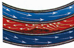
شکل 3-32- تشکیل رسوب در مبدل
