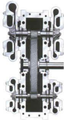
شکل 16-3- نمای داخلی کمپرسور سانتریفوژ 4 مرحله‌ای
