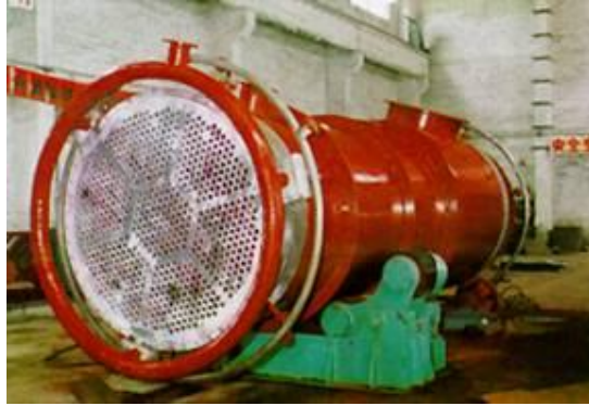
شکل 3-9- مبدل‌های پوسته و لوله Shell & Tube Heat Exchanger
