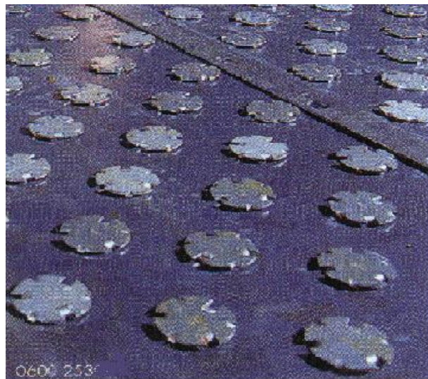
شکل 2-9-نمایی از سینی دریچه‌ای
