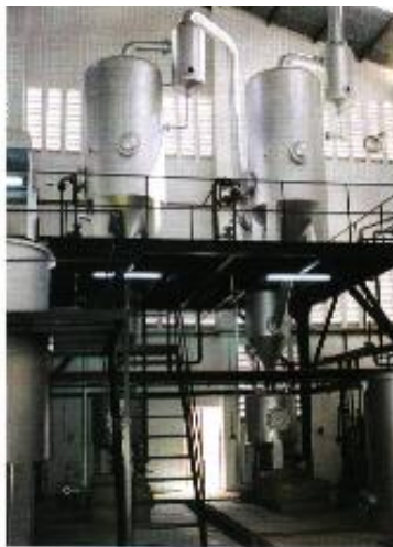
شکل 10-4- یک تبخیرکننده فیلمی دو مرحله‌ای
