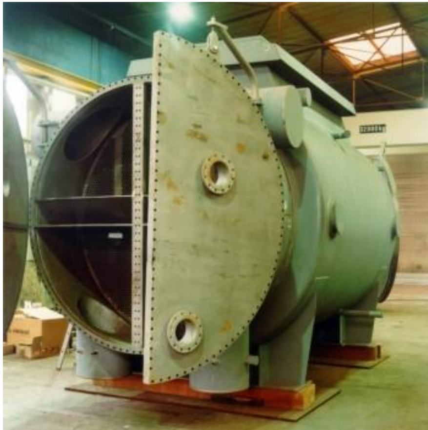
شکل 3-10- مبدل‌های پوسته و لوله Shell & Tube Heat Exchanger
