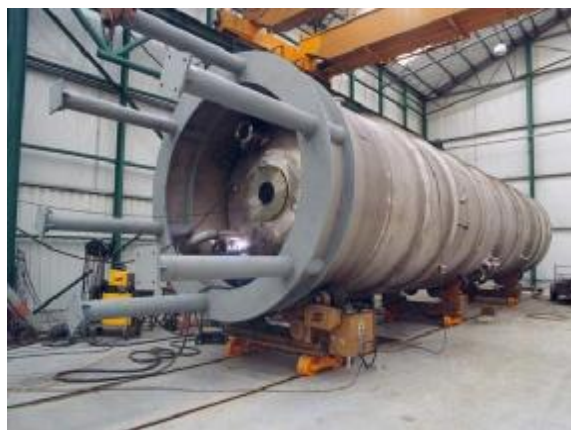
شکل 4-6- دو نمونه صنعتی از ظروف تبخیر ناگهانی
