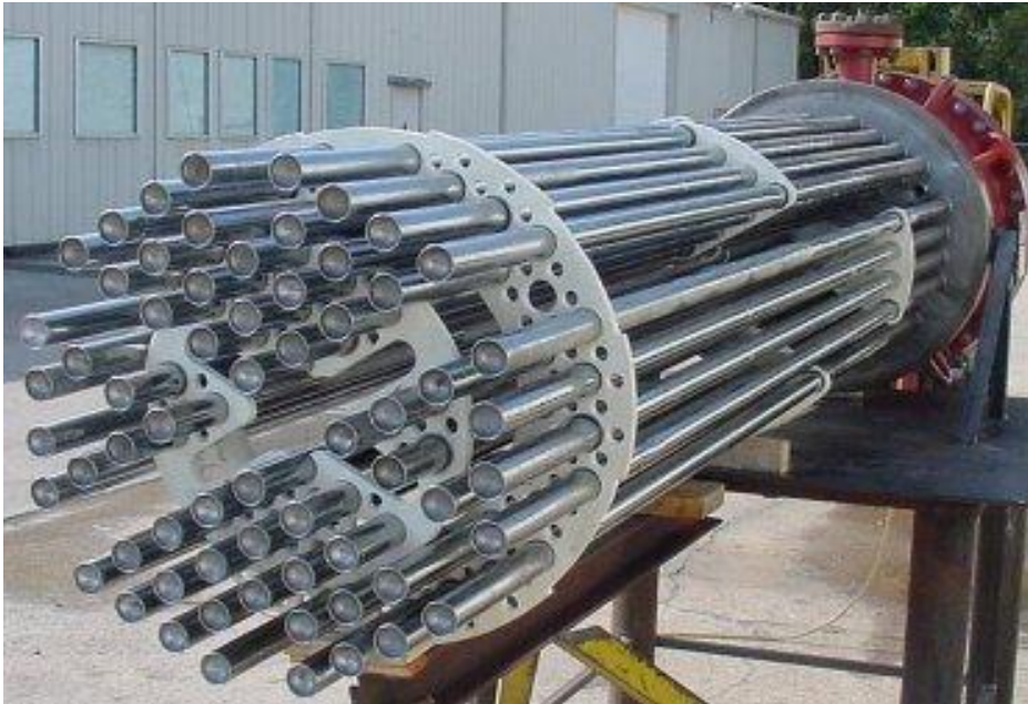
شکل 3-19- آرایش مثلثی لوله‌ها، صفحه تیوب و بافل‌ها در یک مبدل پوسته و لوله
