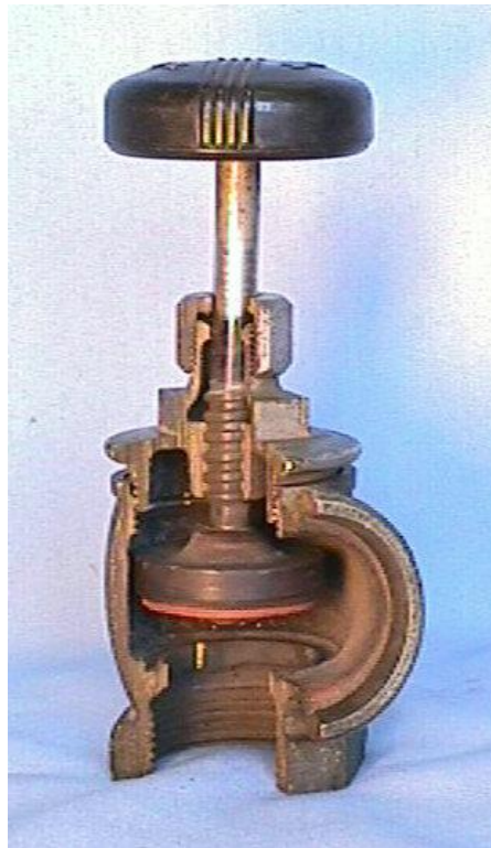
شکل 8-12- نمونه‌ای از شیرهای زاویه‌ای
