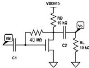
ب 1) با فرض  $C_2=2C_1$  در شکل زیر، همراه با محاسبه مشخص نمایید کدام خازن‌ها تعیین کننده فرکانسهای قطع بالا و یا پایین هستند.
