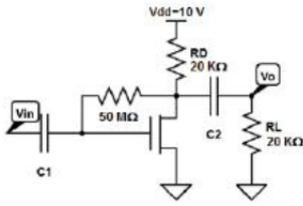
الف 1) با فرض  $C_1=2C_2$  در شکل زیر، همراه با محاسبه مشخص نمایید کدام خازن‌ها تعیین کننده فرکانسهای قطع بالا و یا پایین هستند.
